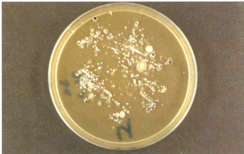
Das mikrobiologische Ergebnis weist Bakterien im Kraftstofffilter nach.
